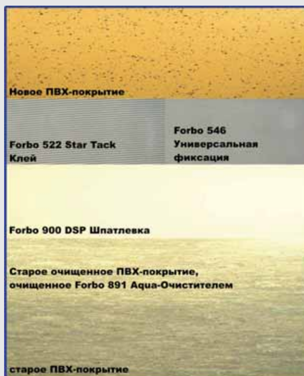
Укладка нового ПВХ-покрытия на старое ПВХ-покрытие
