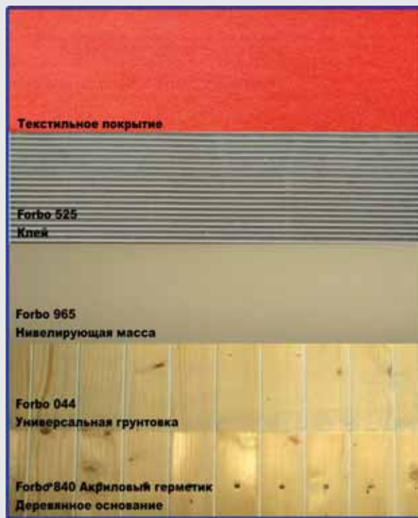
Укладка покрытий на деревянное основание
