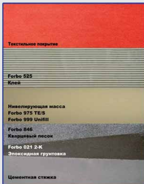
Укладка покрытий на стяжку с повышенной влажностью
