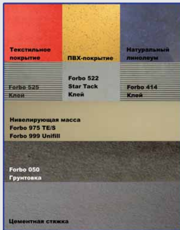
Укладка покрытий на стяжку с повышенной влажностью
